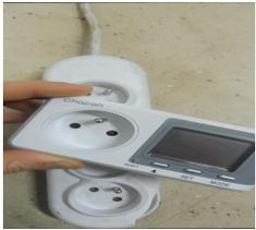
2. Branchez l'appareil électrique dans le wattmètre
