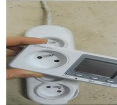
2. Branchez l'appareil électrique dans le wattmètre
