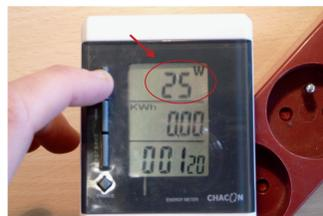
N.B.1.: Si l'appareil est de très faible puissance, les mesures risquent de ne pas être comptabilisées.
