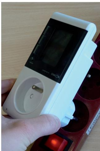
2. Branchez l'appareil électrique dans le wattmètre
